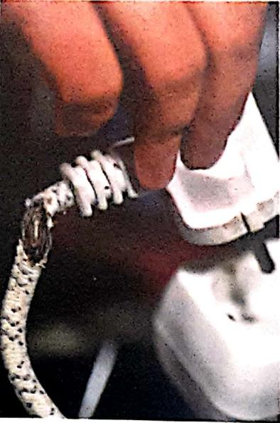
Nunca hay que utilizar aparatos con cables deteriorados.
