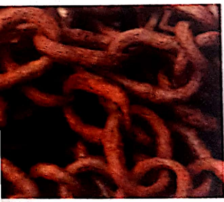
Algunos metales expuestos a la intemperie sufren una reacción de oxidación.
