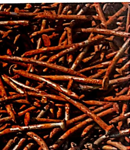
Cuando un clavo se oxida, los átomos de oxígeno que hay en el aire se unen a los átomos de hierro que hay en el clavo y se forma una nueva sustancia, el óxido de hierro.
